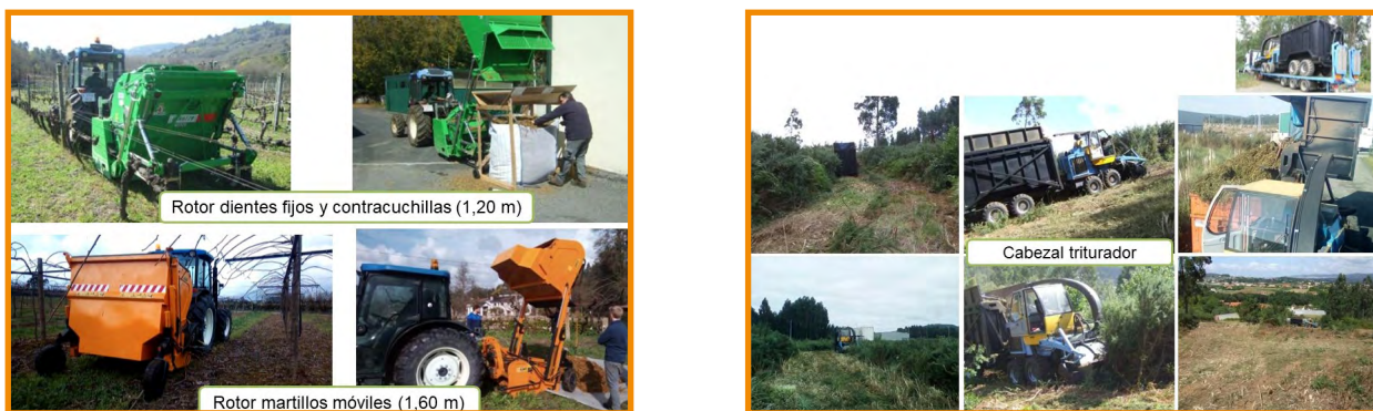
Figura 1: Equipamentos de recolha de restos de videira e kiwi (esquerda) e de matos (Retrabio, direita)
