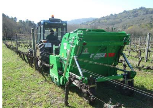
Equipo de dientes fijos y contracuchilla
